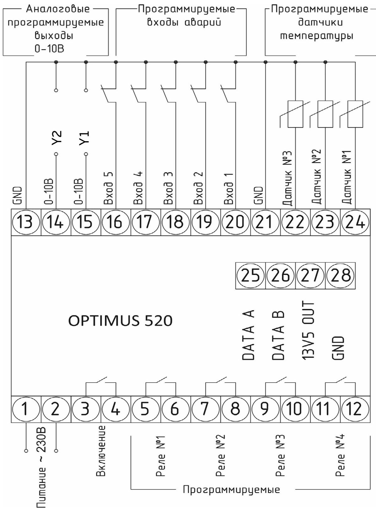
Рис. 2.1 Расположение клемм.
